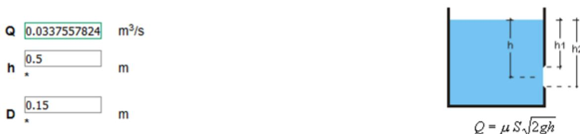
Figura 15 - Dimensionamento della bocca tarata di scarico del pozzetto O1
