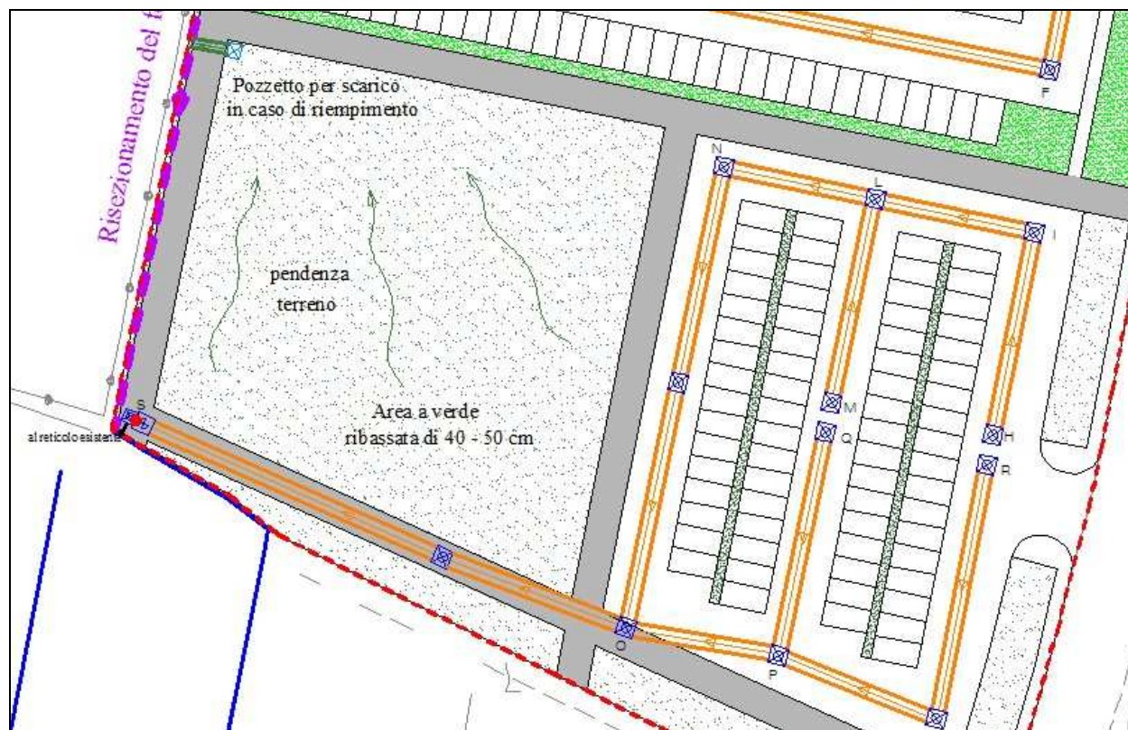
Figura 8 – Estratto della planimetria generale della fognatura delle acque meteoriche a servizio della parte pubblica necessaria per il mantenimento dell'invarianza idraulica
