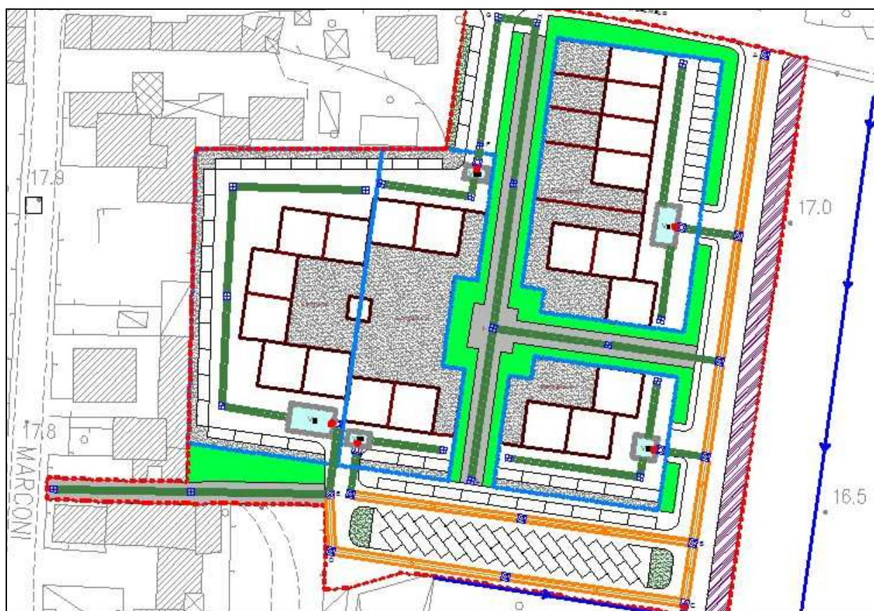
Figura 8 – Estratto della planimetria generale della fognatura delle acque meteoriche a servizio della parte pubblica necessaria per il mantenimento dell'invarianza idraulica
