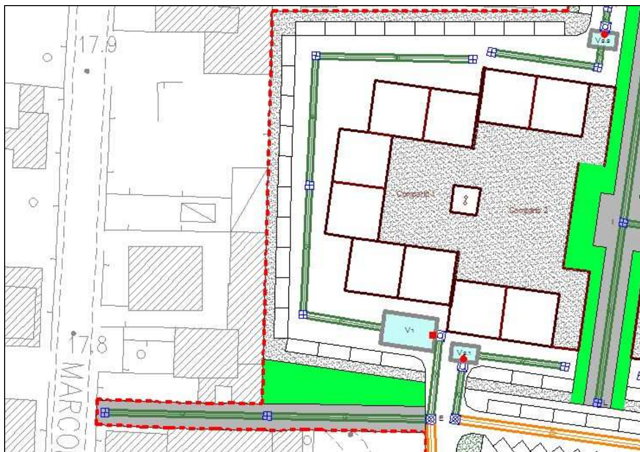
Figura 12 – Particolare del posizionamento dei volumi V 1 , V 2.1 e V 2.2 che garantiscono l'invarianza idraulica nella zona A e B; per un maggior dettaglio si rimanda alla tavola grafica allegata alla relazione
